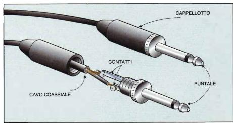
I connettori jack si usano quando occorre collegare e scollegare i dispositivi audio durante l'uso. Si trovano sul mercato nei diametri 2,5 - 3,5 - 6,3 mm nelle versioni mono e stereo e inoltre esistono gli adattatori da un modello all'altro. In un impianto dove ne siano presenti più di uno, per distinguere le varie funzioni, conviene utilizzare quei modelli su cui è possibile fissare delle apposite fascette colorate.
